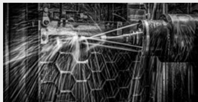
CNC gestuurde bewerkingen van de gietijzeren tafels
