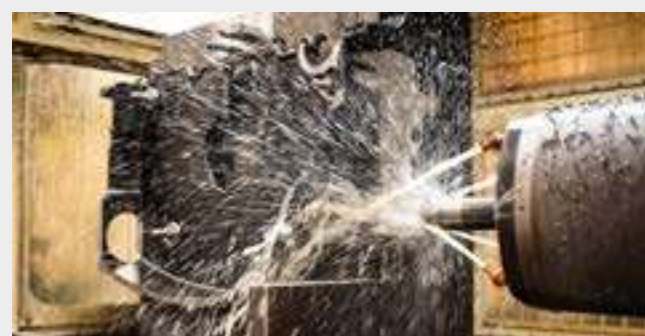
CNC gestuurde bewerkingen op de gietijzeren zaagbeugel
