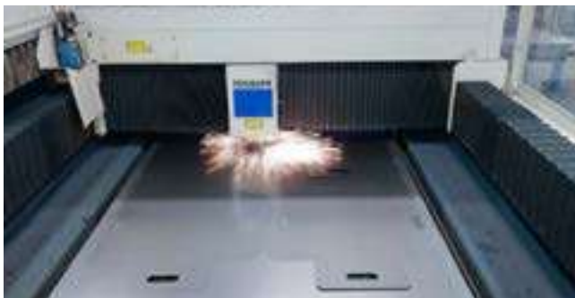
Uitlaseren van stalen plaatmateriaal
