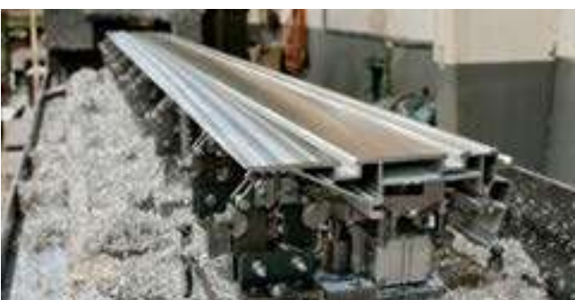
Frezen van de oppervlakte van de loopwagen
